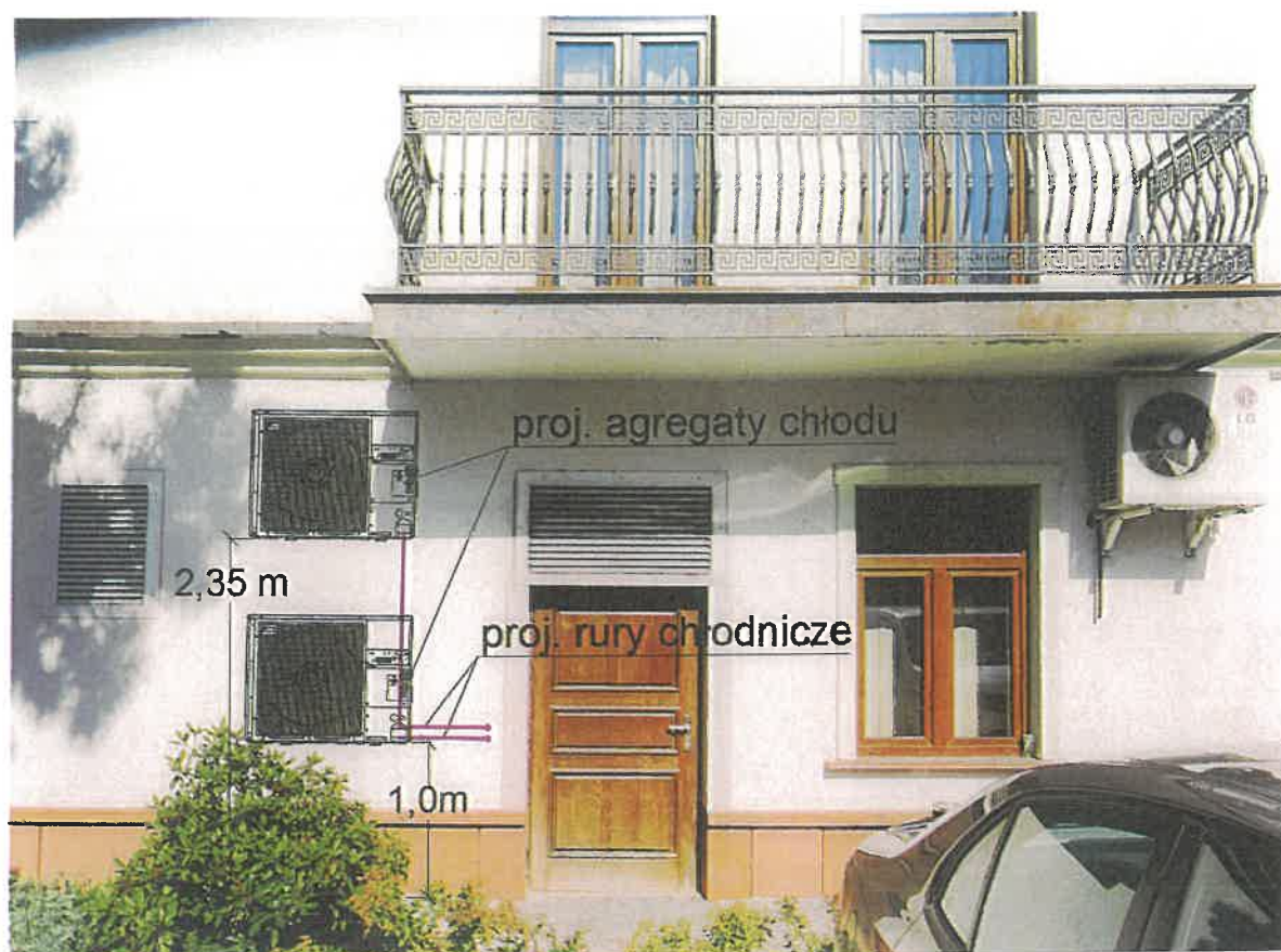
Rysunek nr 2 – Elewacja - lokalizacja agregatów
